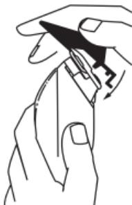
Pour le retirer, soulever l'arrière et dégager la lame.
